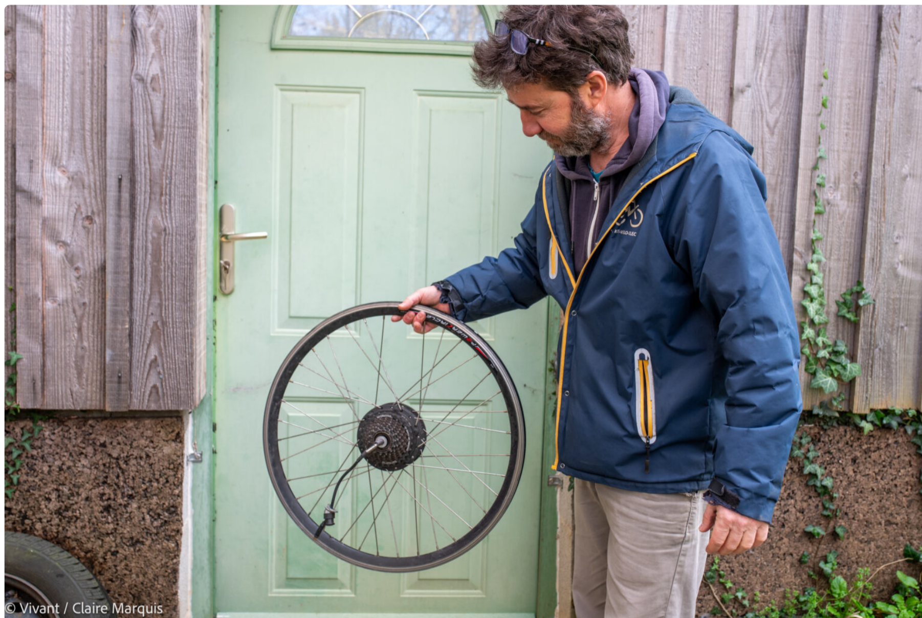
David Sorin, fondateur de Kit Vélo Elec, montre un moteur de vélo électrique qu'il a installé dans le moyeu de la roue
